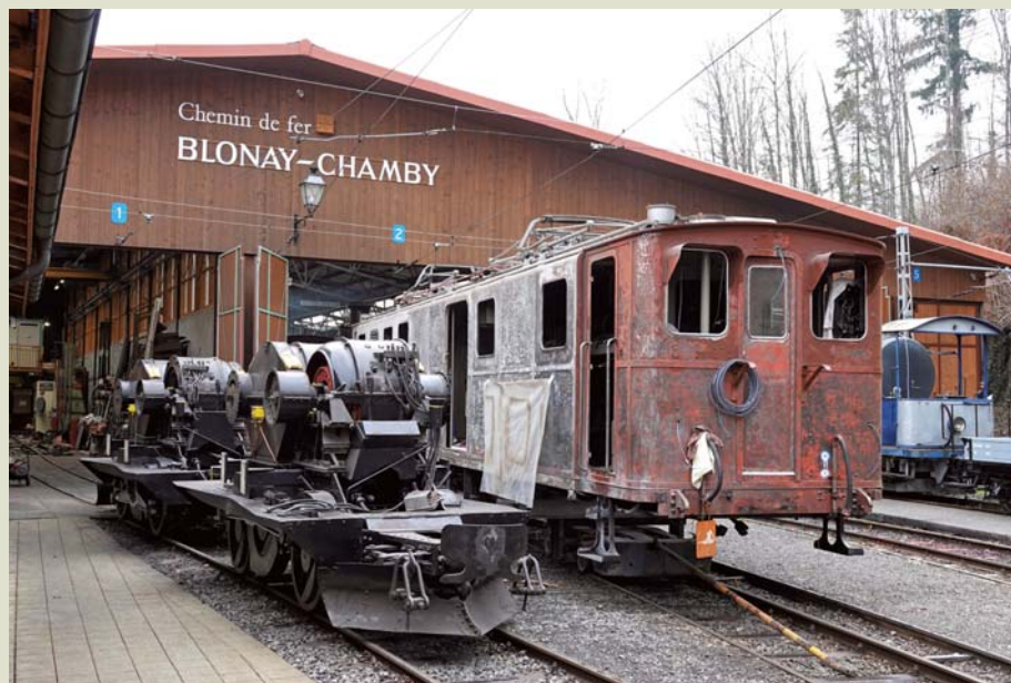
La BB 81, une locomotive électrique construite en 1916 pour le Bernina-Bahn (GR), fait l'objet d'une révision générale entre 2008 et 2018. Remise en service dans son état de 1929. Les bogies, équipées des moteurs de traction, et la caisse sont séparées avant le remontage. Chaulin, 2018.
