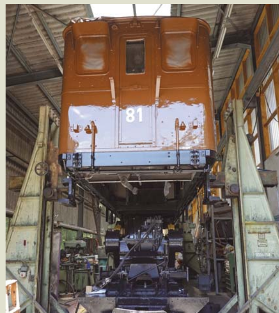
BB 81: opération délicate du levage de la caisse pour loger les bogies moteur. Chaulin, 2018.
