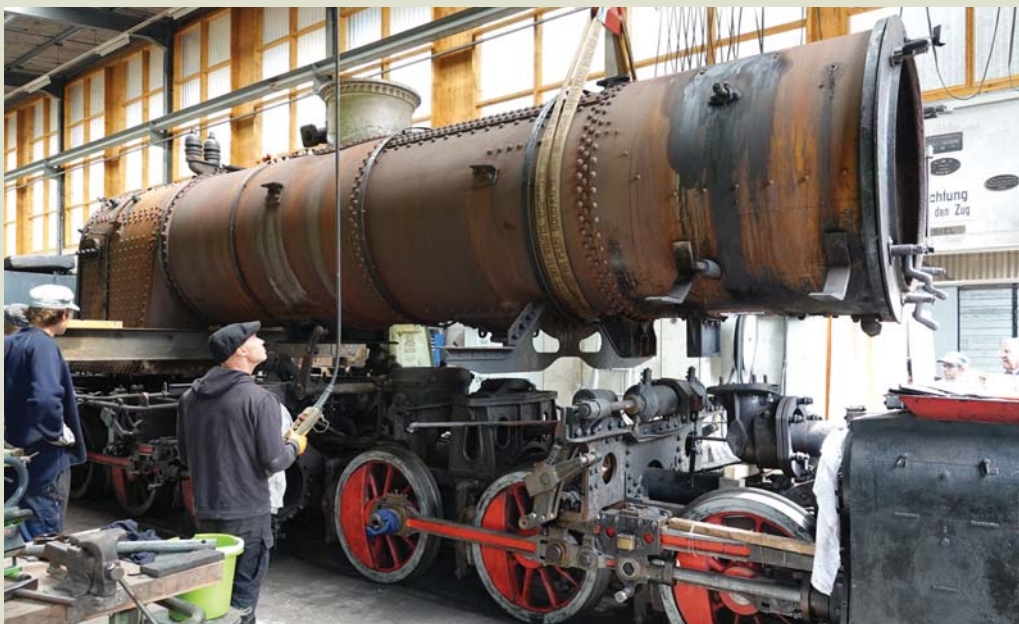
Les travaux de restauration de la SEG 104 sont en cours. Ici levage de la chaudière de la locomotive pour accéder aux 2 châssis. Chaulin, 2019.
